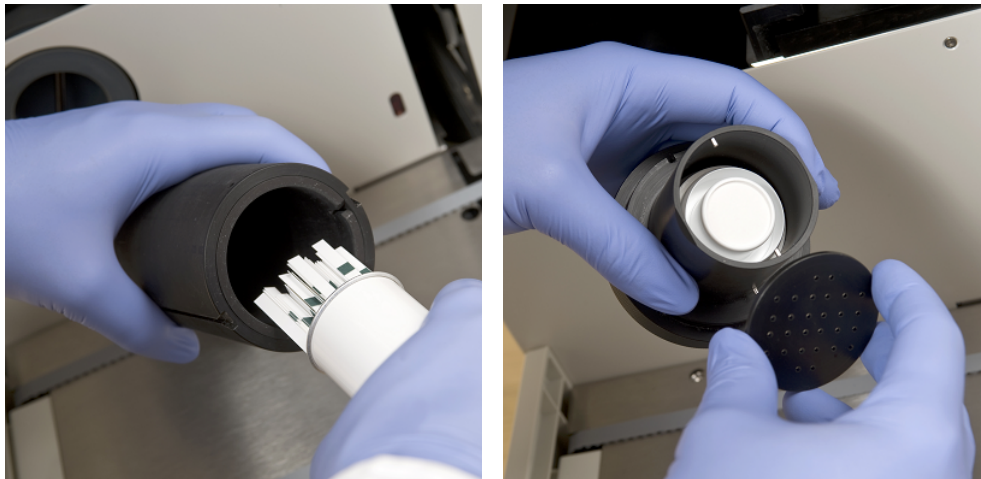
Figura 22: Caricamento delle strisce reattive e dell'essiccante nel cilindro del caricatore delle strisce
