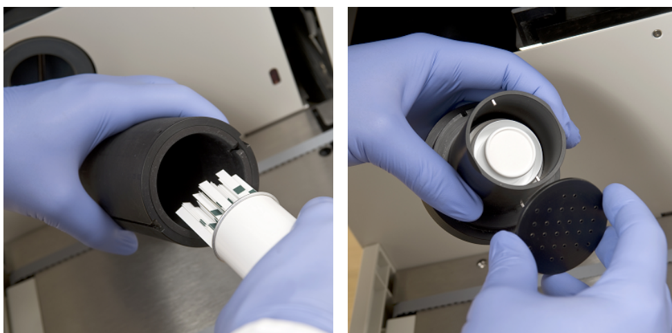
Slika 22: Utovar ispitnih traka i sredstva za sušenje u cilindar za utovar traka
