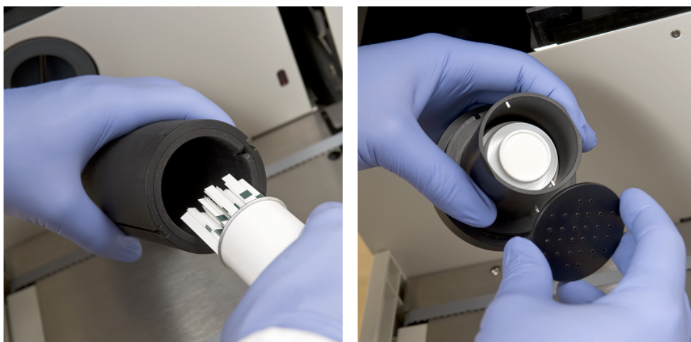
Figura 22: Încărcarea benzilor de testare și a agentului deshidrant în cilindrul de încărcare a benzilor
