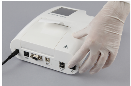
Fig. 5: Apagado del dispositivo
