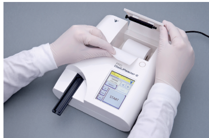
Fig. 4: Carga de la impresora
