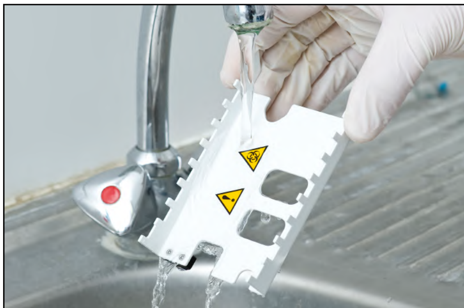
Slika 54: Ispiranje grablji mjerača vremena za trake
