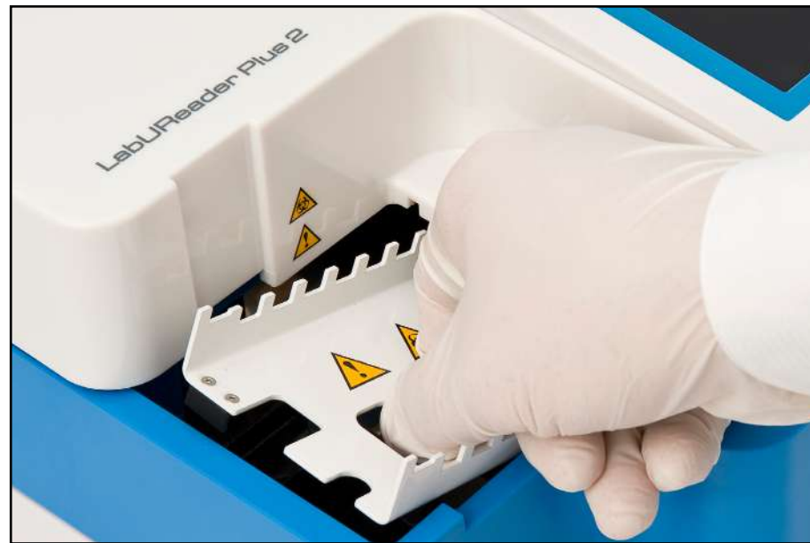
Slika 9: Umetanje grablji mjeraca vremena za trake
