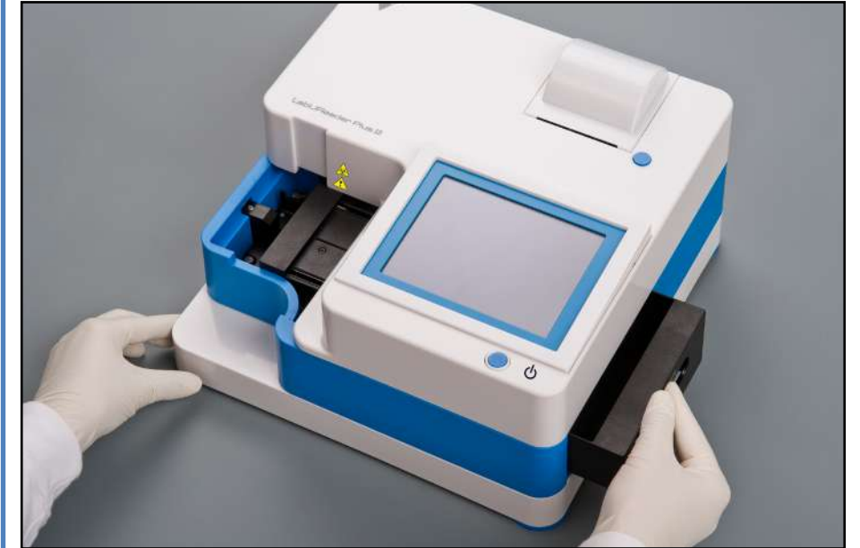
Slika 10: Umetanje plitice za test trake
